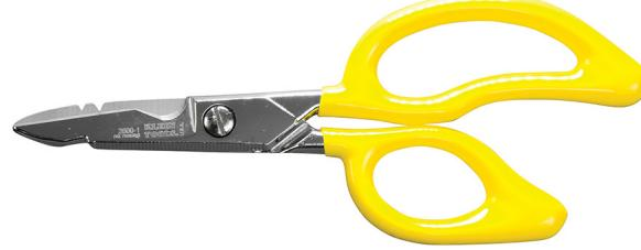
Ces ciseaux d'électricien universels comportent une encoche de coupe pour câbles d'un calibre maximal de 14 AWG, des encoches à dénuder pour câbles de 23 AWG et 19 AWG, des lames de coupe tranchantes et dentelées, ainsi qu'une encoche dans la pointe pour ébavurer des coffrets électriques. La conception unique des poignées enduites convient à de nombreuses préférences de prise.
