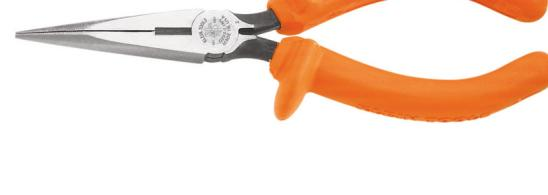
La pince à coupe latérale à bec long isolée Klein Tools est classée 1000 V pour plus de sécurité sur le chantier. Le bec long est conçu pour saisir et replier les fils. L'isolant double orange sur blanc fournit une indication lorsque l'isolant est possiblement abîmé. L'isolant moulé durable satisfait ou dépasse les normes ASTM F1505-16 et IEC 60900:2012 concernant les outils isolés. Les lames des pinces sont trempées par induction pour une longue durée de vie.
